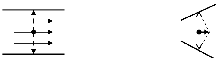
Появление импульса к ускорению при попадании потока в сопло с расширяющимся сечением
